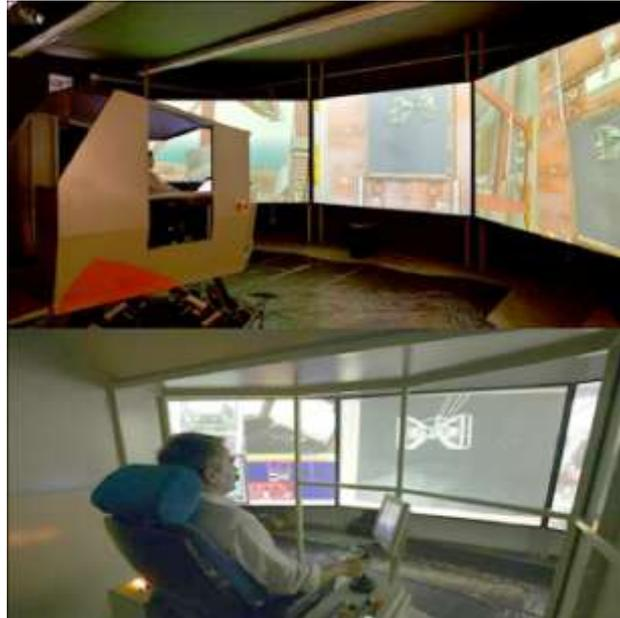
Acompañando a todo esto, existe una pantalla táctil desde la cual se puede controlar todos y cada uno de los elementos que intervienen en el sistema y se puede monitorizar y supervisar toda la descarga.
